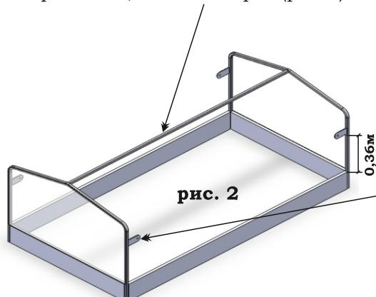
4. Установить пробой ушко на фронтонны на расстоянии 0,36м от верхней кромки доски, закрепить саморезами 4,2\*19мм сверло (рис 2).
