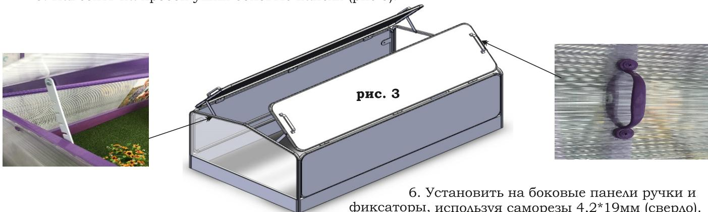
6. Установить на боковые панели ручки и фиксаторы, используя саморезы 4,2\*19мм (сверло).
